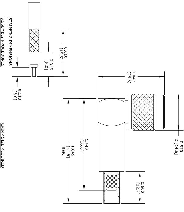
1. STRIP CABLE AS SHOWN. SLIDE FERRULE OVER CABLE & CRIMP CONTACT TO CENTER CONDUCTOR.
